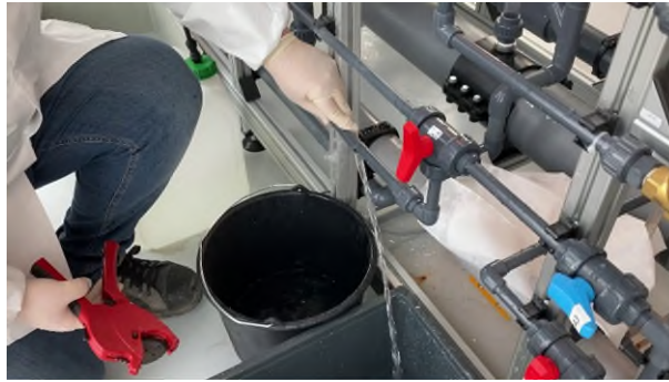
Figuur 25: Snelle en continu uitstroming van water tijdens het uitsnijden van het proefstuk bij de tweede locatie.
