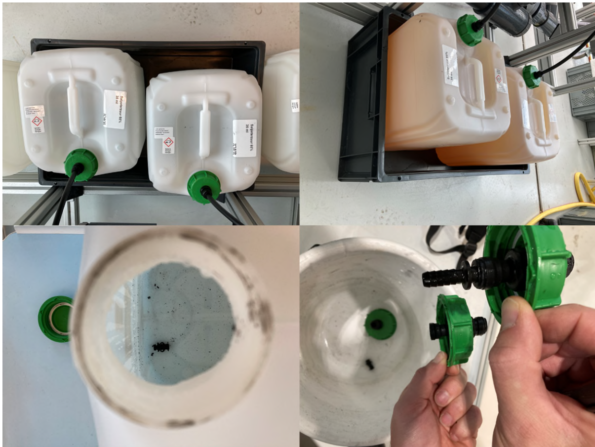
Figuur 83: (Linksboven) Jerrycan voor proportionele bemonstering die vooraf is aangezuurd (Rechtsboven) Verkleuring van jerrycans tijdens het begin van experimenten die later verdwijnt zodra water toegevoegd is (Linksonder) Belanden van PE-onderdelen van monsterafvoer in de jerrycan (Rechtsonder) PE-onderdeel die niet is aangetast door zuurdampen tegen PE-onderdeel die wel is aangetast.
