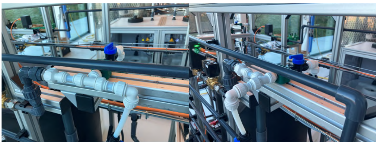
Figuur 84: (Links) Strakke oriëntatie van een monsternamekraan bij de douche ten behoeve van de openingsceremonie van het HomeWaterLab (Rechts) Gewenste oriëntatie van de monsternamekraan.
