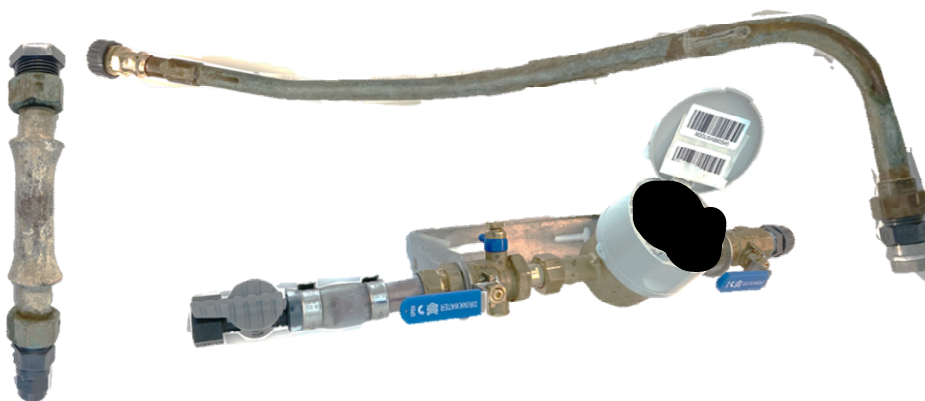
Figuur 6: Foto's van de drie geselecteerde lood afgevende onderdelen. (Links) Korte loden leiding (Rechts boven) koperen leiding met loodsoldeer (Rechts onder) Watermeter met loodhoudende kraan
