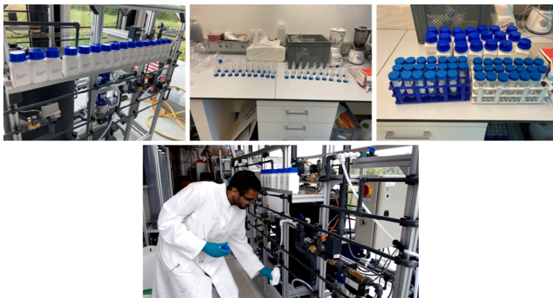
Figuur 15: (Linksboven) Flessen dicht bij de kraan geplaatst in de juiste volgorde (Boven, midden) Voorbereiding van de in te leveren PPE-buizen (Rechtsboven) De in te leveren PPE-buizen na bemonstering (Onder) Nemen van een monster tijdens profielbemonstering.
