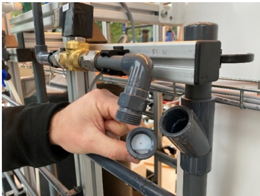
Figuur 78: Een aangepaste warmwatertoestel (extra materiaal tussen messing en PVC). Om een bepaalde volumestroom van de binaire kranen zijn er reduceerplaatjes gemaakt (wit plaatje met een gatje). De grootte van het gatje bepaalt de mate van volumestroom. Het plaatje is direct na het einde van de binaire kraan geplaatst. Een uitzondering is de badkamerkraan voor warmwater (in beeld) dat het enige binaire warmwatertappunt is. Het plaatje daarbij is bij de afvoerpunt geplaatst. Dit is nodig wegens de materiaalkeuze bij warmwatertappunten.
